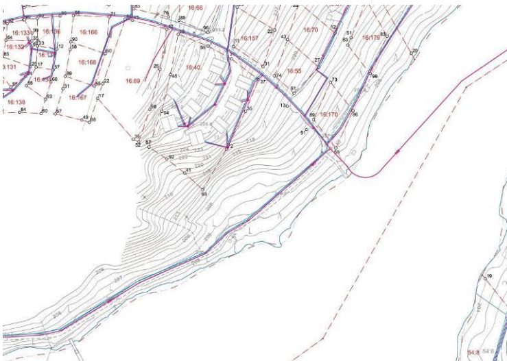
Kuva 5 Alueen johtoverkot. Sinisellä vesijohto ja punaisella viemäri, oikealla alueen koilliskulmassa oleva pumppaamo (Kuva: Ulla-Maija Oikarinen 7.8.2019)
