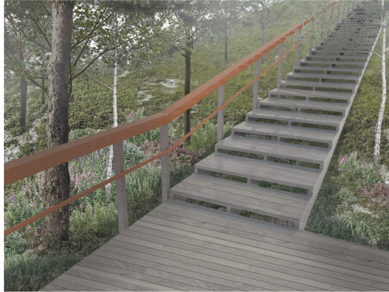
Väri vaihtoehto 5 " Tyrni " Porras sekä kaidetolppa harmaat, käsijohteet oranssit. Puu käsitelty harmaaksi tai annettu harmaantua. Oranssi sävy esim tikkurila valtti wood oil (sävy orava tai kettu)
