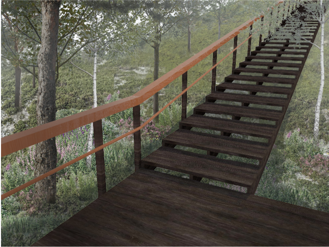
Väri vaihtoehto 4 " Hilla " Porras sekä kaidetolpat käsitelty tummaksi, käsijohteet oranssit. Esim. Tikkurila valtti wood oil (sävyt piki sekä orava/kettu)
